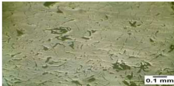
Gambar 4. Struktur mikro material silinder blok
