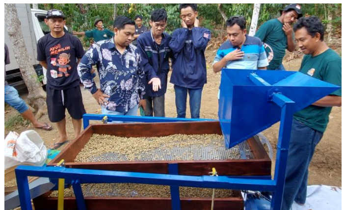
Gambar 5. Proses penggunaan alat/mesin sortir
